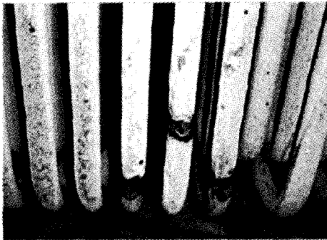
그림 4 손상된 테프론 코팅 GGH Tube
