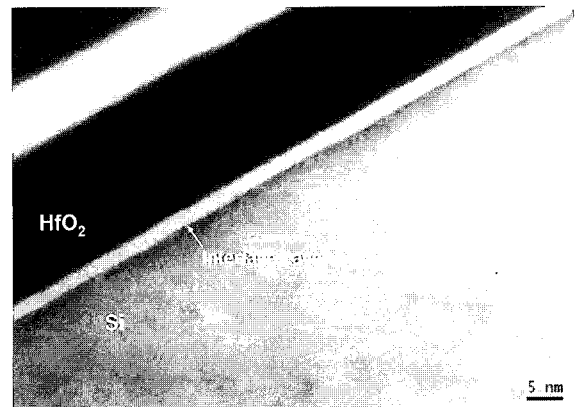
그림 3. 실리콘 위에 증착된 HfO 2 /Hf/Si 박막의 TEM 단면도 Fig. 3. A cross section TEM image of HfO 2 /Hf/Si thin film on silicon.
