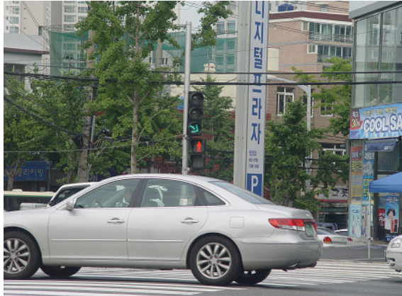
〈그림 2〉 교차로에 설치된 변형 차량 보조 신호등
