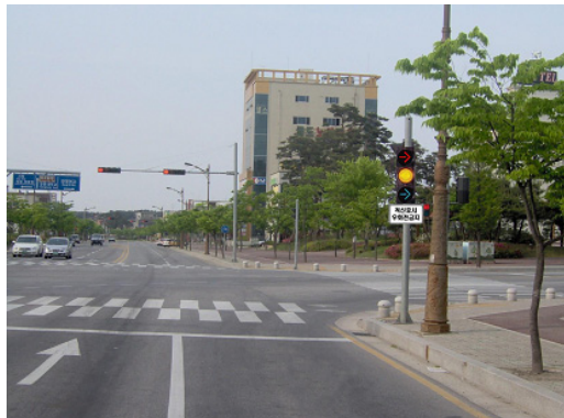
〈그림 17〉 우회전 녹색 및 적색 화살표를 활용한 삼색 보조 신호등 개선 예
