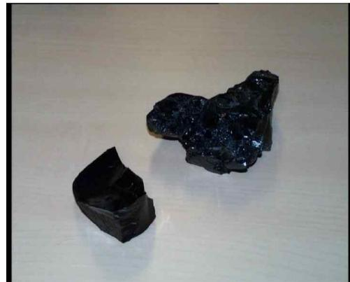
[그림 23] 고온 용융에 의한 폐석면의처리 상태
