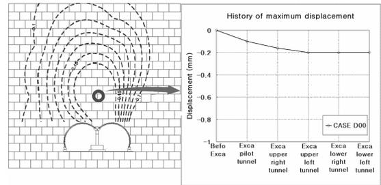
그림 5. 지중변위 등고선 및 최대변위이력 (CASE D00)
