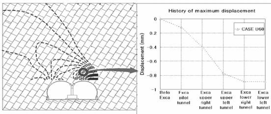
그림 7. 지중변위 등고선 및 최대변위이력 (CASE D60)
