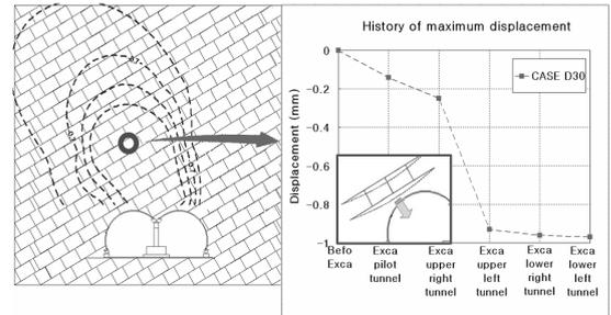
그림 6. 지중변위 등고선 및 최대변위이력 (CASE D30)
