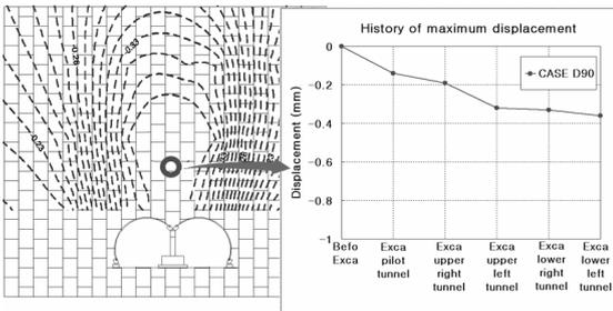
그림 8. 지중변위 등고선 및 최대변위이력 (CASE D90)
