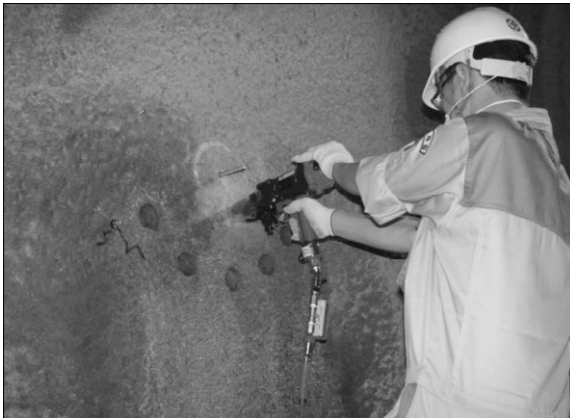
그림 14. 공기압식 pin 관입시험에 의한 슛크리트 강도 추정
