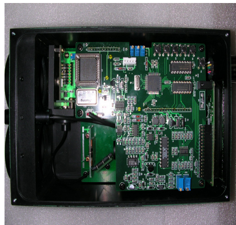
그림 8. 구현한 산업용 레이저 거리 계측기 Fig. 8 The industrial Laser distance instrument which embodies
