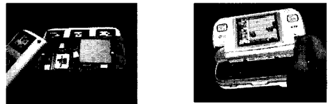
그림 2. 촉각 피드백의 기술적 구현 (a) 감각형 객체의 내부. (진동모듈, 블루투스모듈, 제어모듈, 배터리 내장) (b) 자동차가 벽 또는 자동차와 충돌했을 경우 진동의 강도를 최대로 함.
