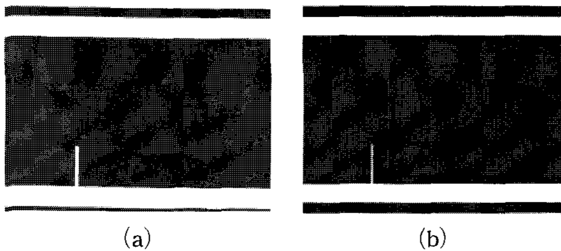
[그림 9] 현상 공정후 (a) 현상액에 의하여 손상 받은 ITO, (b) 농도가 높은 현상액을 사용하여 현상 시간을 줄임으로써 손상 받지 않은 ITO
