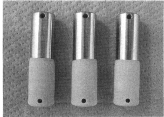
사진 1. Carbonbuster-141을 침적도포한 환봉시험편의 외관.
