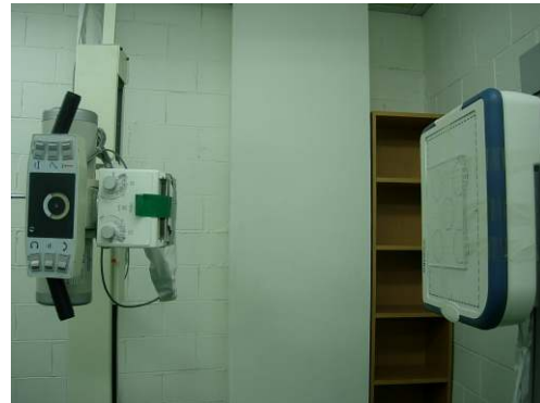
그림6. Contrast-detail 곡선을 획득하기 위한 실험장치 구성
