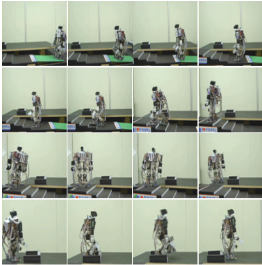
그림 3. 소형 이족보행로봇 운동 계획 실험 결과
