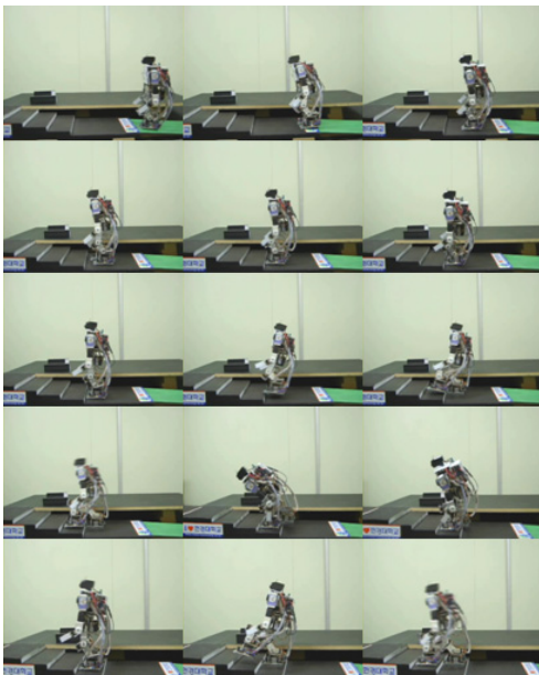
그림 4. 부목표점을 이용한 계단 보행 실험 결과
