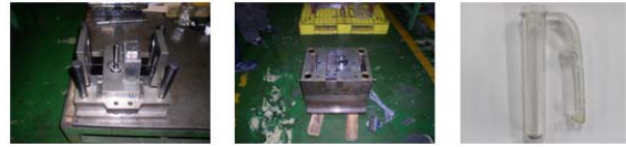
(a)금형의 cavity부 (b)금형 core부 (c) 사출성형제작 그림 9. 프리폼 금형 제작 및 사출 성형품 제작.
