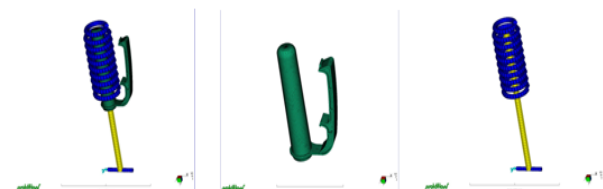
(a) 전체조립도 (b) 프리폼 (c) 냉각 채널 그림 3. 프리폼, 주입기구 및 냉각채널 유한요소 모델링.
