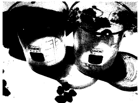
(b) 왼쪽 비커 : 아스팔트 릴리스 에이전트 B 속에 개질아스팔트 혼합물을 넣은 경우(10분 경과), 오른쪽 비커 : 혼합물을 넣지 않은 경우
