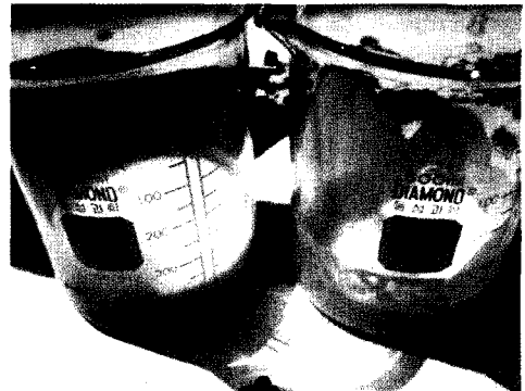
(b) 왼쪽 비커: 아스팔트 릴리스 에이전트 B 속에 일반아스팔트 혼합물을 넣은 경우(10분 경과), 오른쪽 비커: 혼합물을 넣지 않은 경우
