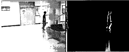
그림 2. 움직임검출 영상에 대한 히스토그램 투영 Fig. 2. Histogram projection of a motion detected image
