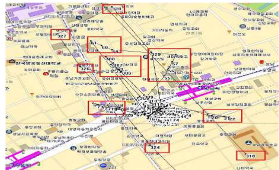
그림 8. GPS 위치 측위 위치정확도 보정 전(1) Fig. 8. Before compensation of Position error (1)
