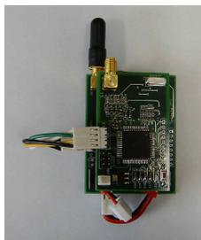
그림 5. 지그비 노드(Zigbee Node)와 연결되도록 제작된 RFID 리더
