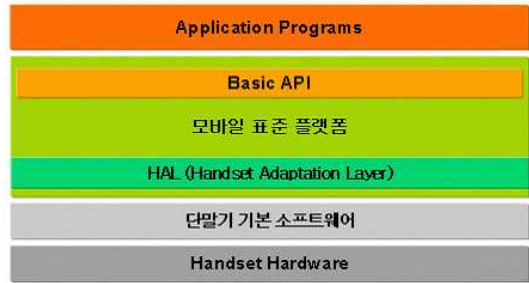
그림 1. WIPI 플랫폼의 구조도 Fig. 1. Structure of WIPI platform
