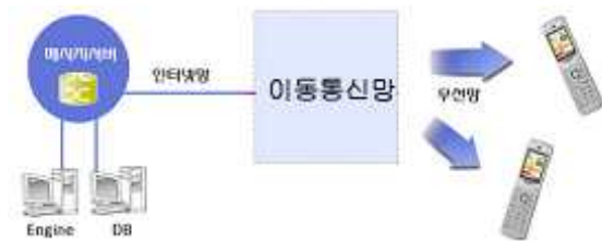
그림 3. 모바일 커플게임의 시스템 구조 Fig. 3. System structure of mobile couple game
