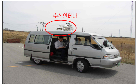
그림 7. 차량을 이용한 로란-C 측정전경 Fig. 7. Loran-C measurement using the automobile
