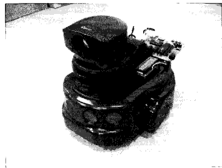
그림 7. 3D구조의 초음파 센서모듈 및 카메라. Fig. 7. 3D Ultrasonic sensor module and camera.
