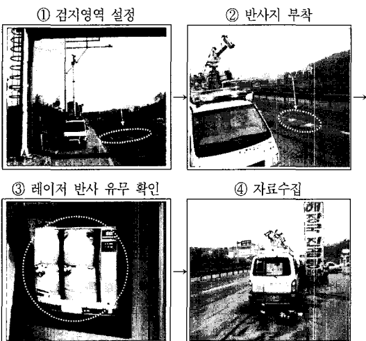
<그림 5> 레이저방식 교통자료수집시스템 자료수집 절차
