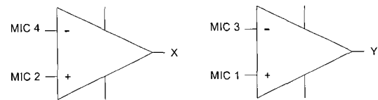
그림 2. 음원의 위치 영역 검출을 위한 비교기 Fig. 2. Comparator for detecting the source position area
