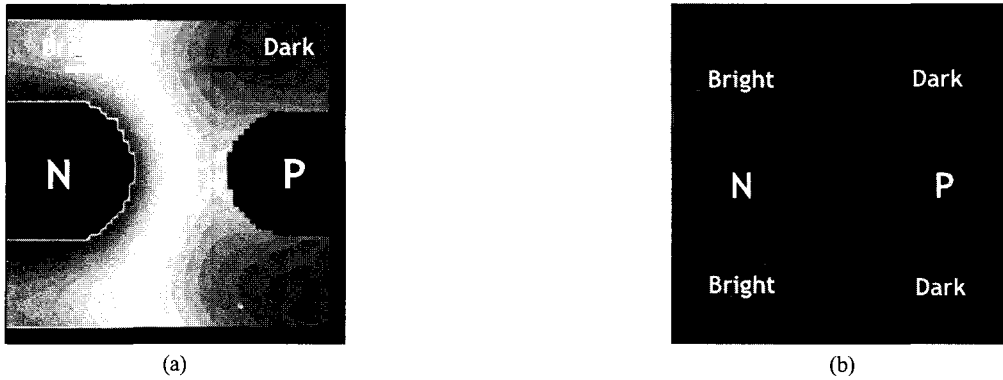
그림 11. 320×320 \mu\text{m}^2 면적의 청색 LED의 (a) 해석된 전류 분포와 (b) 측정된 광 분포.
