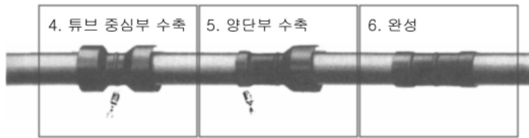
그림 9-2. 방식용 열수축 튜브의 사용 예.
