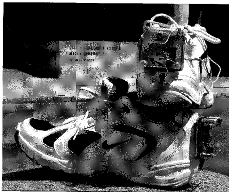
그림 1. 신발에 장착된 압전체 에너지 하비스터[3].
