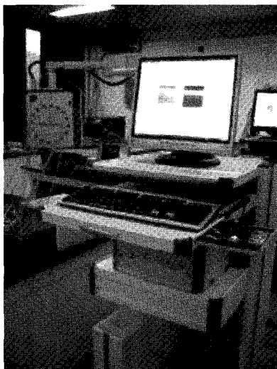
그림 12. 16채널 다주파수 임피던스 단층촬영 시스템 Fig. 12. 16-channel multi-frequency EIT system
