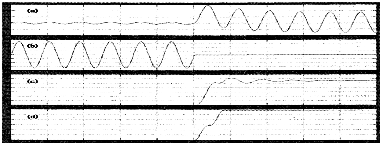
그림 11 고장점 상단과 하단에서 고장상 전류와 영상전류 크기(x : 시간[sec], y : 전류크기[A])
