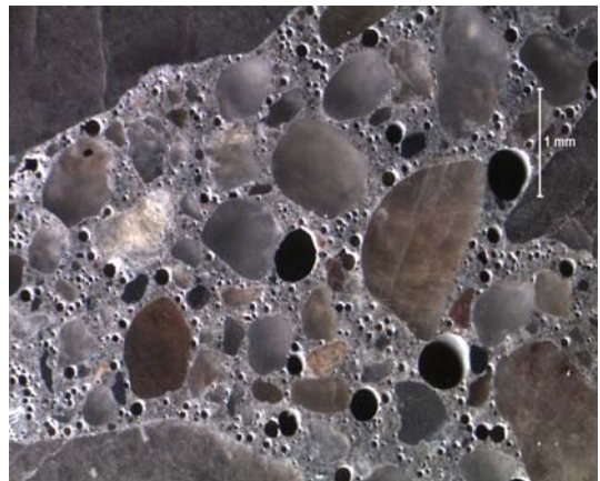
그림 4. 콘크리트 혼합재료 CM의 공기-간극 분포
