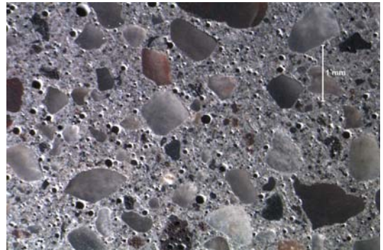
그림 2. 콘크리트 혼합재료 B50의 공기-간극 분포
