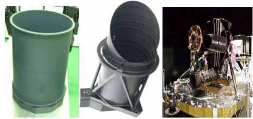
그림 13. 다양한 형태의 경통구조물 형태(좌 : 실린더형, 중 : 트러스트+실린더, 우 : 바(bar)형)
