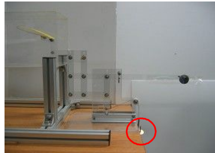
[그림 22] 추를 사용한 항력 측정
