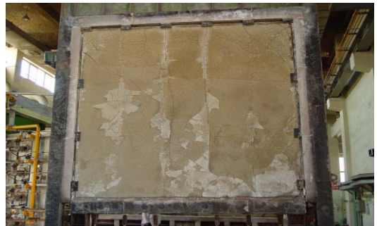
② 120분 경과 후 시험체 내부 가열면
