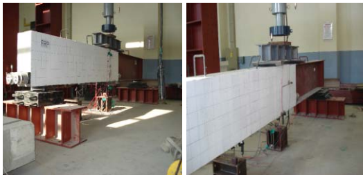
(a) FRP (b) FLP Fig. 5 강-PSC 혼합구조의 휨 실험
