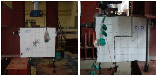
(c) SRP (d) SLP Fig. 6 강-PSC 혼합구조의 전단 실험
