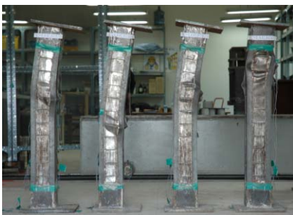
Fig. 14 편심(L/B=7.5) 실험체의 파괴양상
