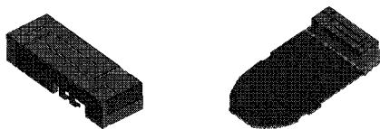
(a) 내장형 안테나 (b) PCB에 장착 그림1. HFSS를 이용한 3D 모델 Figure 1. 3D modeling Using HFSS
