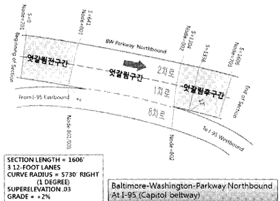
<그림 1> 조사지점의 연결로 합류부의 기하구조 <Fig. 1> Layout of a section on the Baltimore Washington Parkway at I-95 in the U.S.
