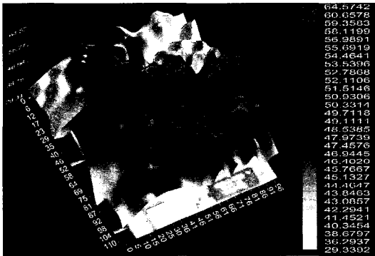
(b) 3D 근접 자계 측정 결과(125 MHz)
