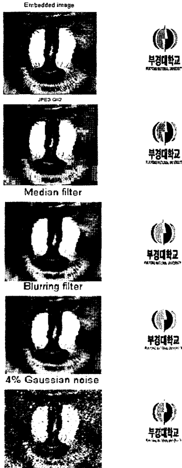
그림 8. (a) 공격을 가한 영상 (b) 추출한 워터마크 Fig.8 (a) Attacked image (b) Extracted watermark
