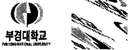
그림 1. 원 워터마크와 Arnold 변환 후 워터마크 Fig. 1 Original watermark and Arnold transformed watermark
