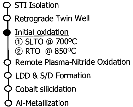
그림 1. 실험을 위한 CMOS 제작 공정 흐름도 및 초기 산화막 형성 Split.
