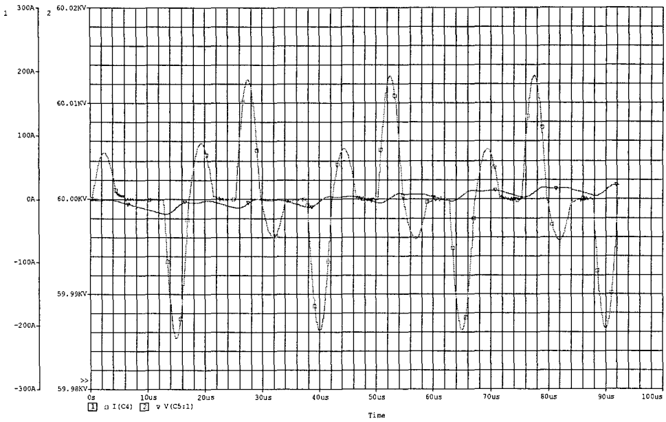
그림 12 충전시뮬레이션 결과(충전전류, 충전전압) Fig. 12 Simulation Results for Charging(Charging Current, Charging Voltage)
