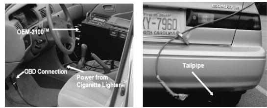
〈그림 4〉 실험차량의 구성(자료출처: Alper Unal et al, 2003)
