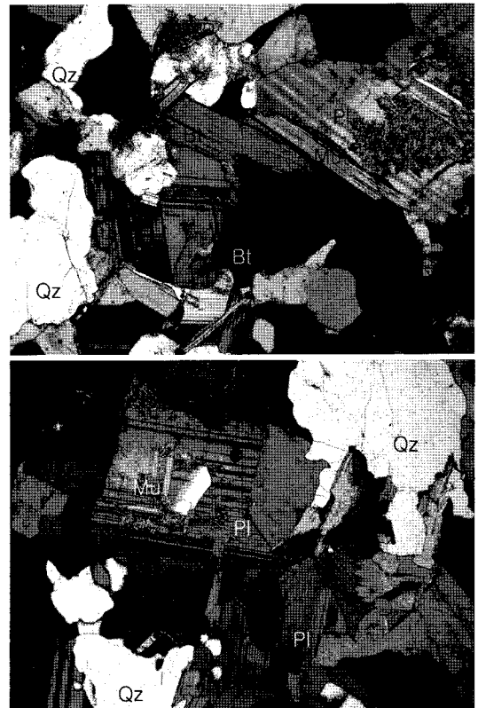
그림 1. 시료의 현미경 사진(40X, cross nicol, 0.5 cm=100 μm, Qz; Quartz, Mu; Muscovite, Pl; Plagioclase, Bi; Biotite, Mi; Microcline, Bt=biotite)
