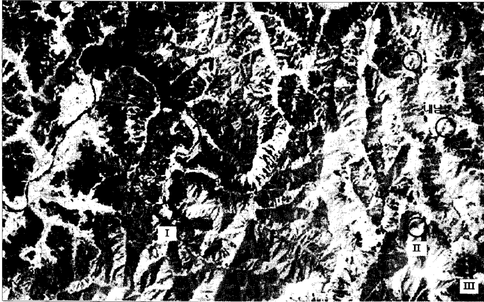
Fig. 10. 위성영상(Landsat Band 7, Soil Index 영상, ASTER Band 8)을 이용한 변질 광화대 추출 결과. (I) 주차장, (II) 나지, (III) 채석장
