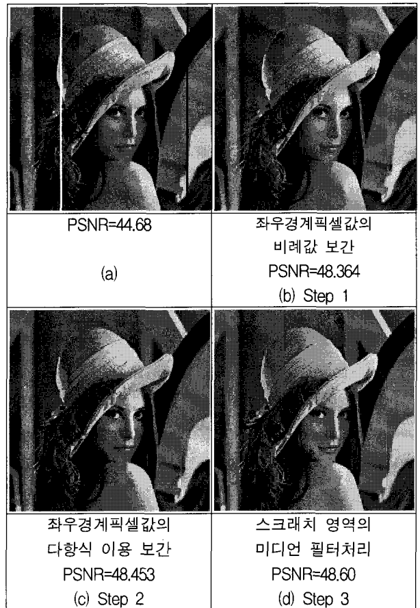
그림 6. 라인 스크래치가 있는 Lena 영상의 복원 단계 Fig. 6. Recovery procedure of Lena image with B/W line scratch.
