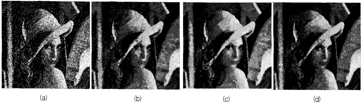
그림 3. (a) 가우시안 잡음으로 열화된 이미지( \sigma_n^2 = 924 , PSNR = 20dB ) (b) Perona-Malik 확산 알고리즘의 출력 이미지( \sigma_n^2 = 153.3 , PSNR = 26.3dB ) (c) ALSAF의 출력 이미지( \sigma_n^2 = 137.6 , PSNR = 26.8dB ) (d) ALMF의 출력 이미지( \sigma_n^2 = 155.2 , PSNR = 26.2dB )
