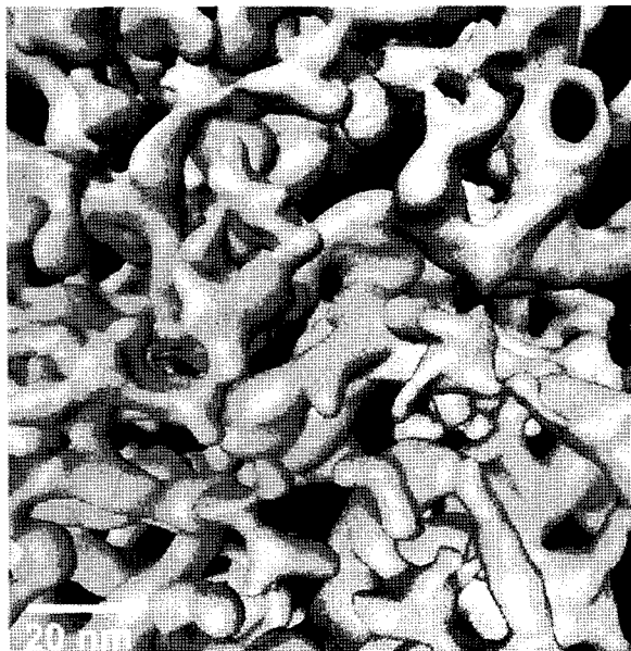
Fig. 12. STEM의 HAADF를 이용하여 얻은 나노기공체 금박의 삼차원 영상 9) .
