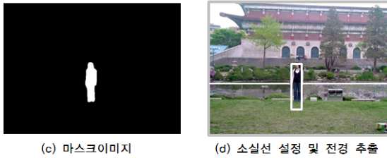
그림 6 사진을 이용한 3차원 내비게이션을 위한 입력영상과 소실선 및 전경 추출 결과
