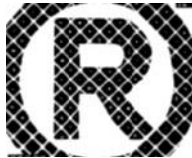
그림 3. 간접식 레이저 각인 방식으로 제작된 그라비아 인쇄를 표면(100 \ell /cm)
