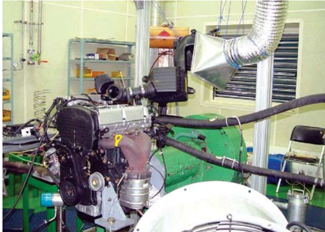
그림 9. 가솔린엔진장착 실험장치 및 대상엔진
