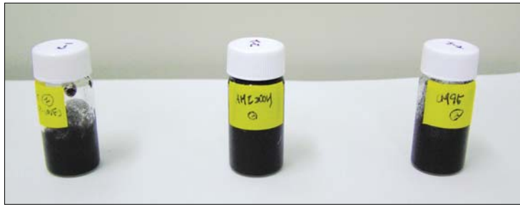
그림 5. 제작된 CNT-incorporated UV-NIL 레진
