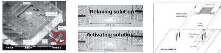
그림 7. Picture of cellular force sensro using MEMS device
